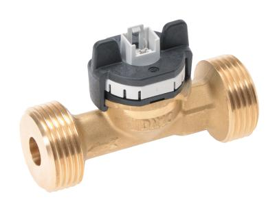
Датчик типа 235 отличается от датчика типа 200 корпусом, который изготовлен из латуни. Датчик расхода типа 235 основан на принципе измерения вихревой дорожки Кармана. Заказчик может выбирать из нескольких модификаций устройства, включая версии со встроенным модулем измерения температуры. Не имея подвижных частей, датчик расхода не чувствителен к загрязнениям, обладает минимальными потерями давления и обеспечивает высокую точность.
